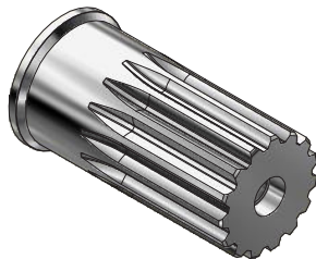
SHAFT W DIN 5482 B25 x 22h9 4z1.6mx30Px9h
